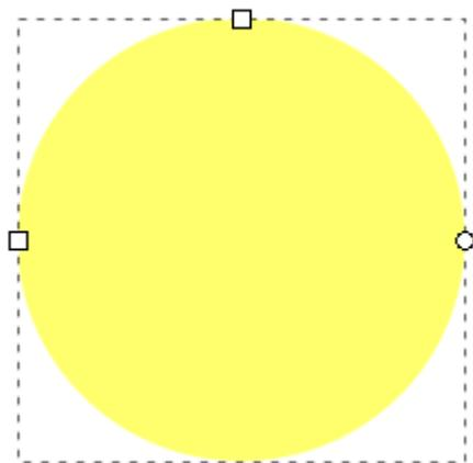
Mais en fabrication numérique, on a besoin des points de la trajectoire à suivre, autrement dit des points du cercle lui-même... d'où la **nécessité d'une conversion de la trajectoire de l'objet en une liste de points reliés entre eux par des segments**.
